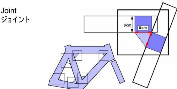
The joint between frame section must fall within the hilighted triangle whose two sides have the same measurement as the height of the section, I.E. 8cm. フレーム部材間のジョイントは強調表示した三角形の中に収まらなければならず, その二つの側面の寸法は部材の高さと同等, すなわち8 cmまでとする.
