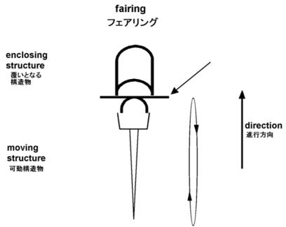
Practical way of confirming the existence of fairing on a moving part such as a wheel: it should be possible to pass a rigid card (like a credit card) between the fixed structure and the moving part. 車輪のような可動部分のフェアリングの存在を正当化する実際的な方法: 硬いカード(クレジット・カードのような)を固定構造部と可動部品の間に通すことができること.
