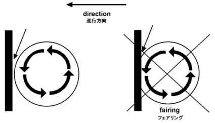
A fairing shall be defined as a the use or adaptation of a component of the bicycle in such a fashion that it encloses a moving part of the bicycle such as the wheels or the chainset. Therefore it should be possible to pass a rigid card (like a credit card) between the fixed structure and the moving part. フェアリングとは,自転車の車輪,チェーンセットのような運動部分を覆う形式の自転車の構成要素を使用または変形することであると定義する.したがって,固定構造部と可動部品の間には,硬いカード(クレジット・カードのような)を通すことができなければならない.
