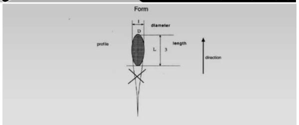
A fuselage form shall be defined as an extension or streamlining of a section. This shall be tolerated as long as the ratio between the length L and the diameter D does not exceed 3. な知られたは、野南における延見または海道化と完善する。これは、馬さした名見の比において、3を招きたい範囲まで許容
