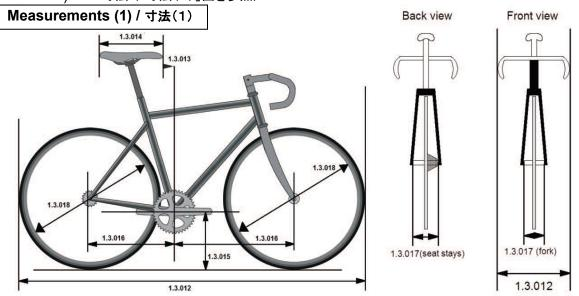
**1.3.012** A bicycle shall not measure more that 185 cm in length and 50 cm in width overall. 自転車は全長185cm以内、全幅50cm以内でなければならない。
