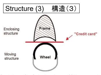
Practical way of confirming the existence of fairing on a moving part such as a wheel: it should be possible to pass a rigid card (like a credit card) between the fixed structure and the moving part. 車輪のような可動部分のフェアリングの存在を正当化する実際的な方法: 硬いカード(クレジット・カードのよう
