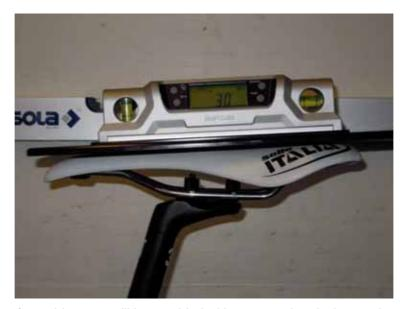
The commissaires at aforesaid events will be provided with a measuring device as shown in the image below. Checks will not be systematic, but in the event of any doubt, the commissaires will place the device on the saddle to determine its angle of incline after having calibrated the device to the ground or the measuring jig. 前述の大会のコミセールは下記画像に例示するような測定機器を提供されよう. 検査は体系的にならないであろうが、いかなる疑いのある場合にも、コミセールは、地面または測定ジグで測定機器を目盛り補正した後に、傾斜角度を決定するために測定機器をサドルに置く.
