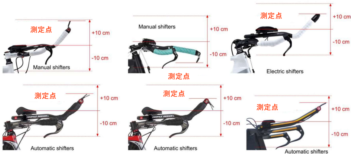
Figure 46: Points of measurement for the vertical limits of the fixed additional time trial extensions and any accessories 図 46: 付属品を含むタイムトライアル用固定エクステンションの垂直位置限界の測定点
