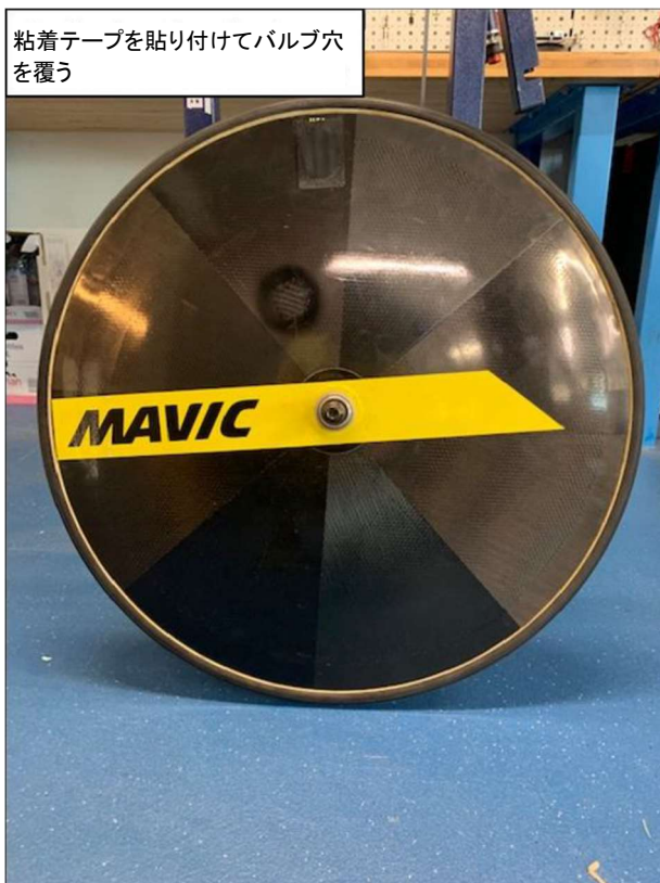
Figure 3: Example of application the adhesive tape on the Time Trial disc wheel 図3: タイムトライアル・ディスクホイールへの粘着テープ貼付の例
