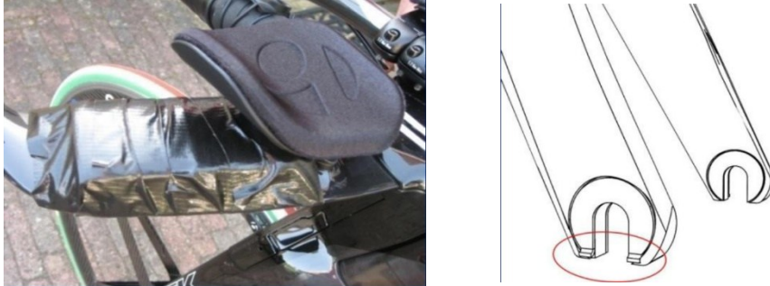
Figure 1: Examples of the prohibited modification of equipment (addition of tape, filing off fork drop-out safety lugs) 図1: 禁止されている機材への部分的な改造の例(テープの追加、フォークの安全ラグの削り落とし)
