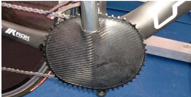
Figure 2: Example of the prohibited modification of equipment (the carbon cover added to the chainring) 図2: 禁止されている機材への部分的な改造の例(チェーンリングへのカーボンカバーの付加)
