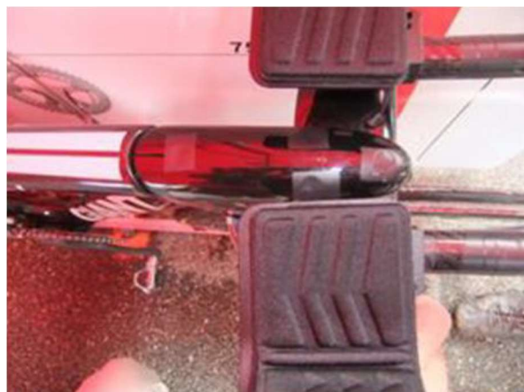
Figure 4: Illustration of the addition of the adhesive tape to cover bolts access 図4: ボルトアクセスホールをカバーする粘着テープ付加の説明図
