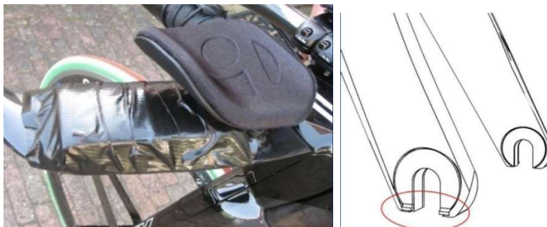
Figure 1: Examples of the prohibited modification of equipment (addition of tape, filing off fork drop-out safety lugs) 図1: 禁止されている 機材 への 部分的な改造 の例(テープの追加、フォークの安全ラグの削り落とし)
