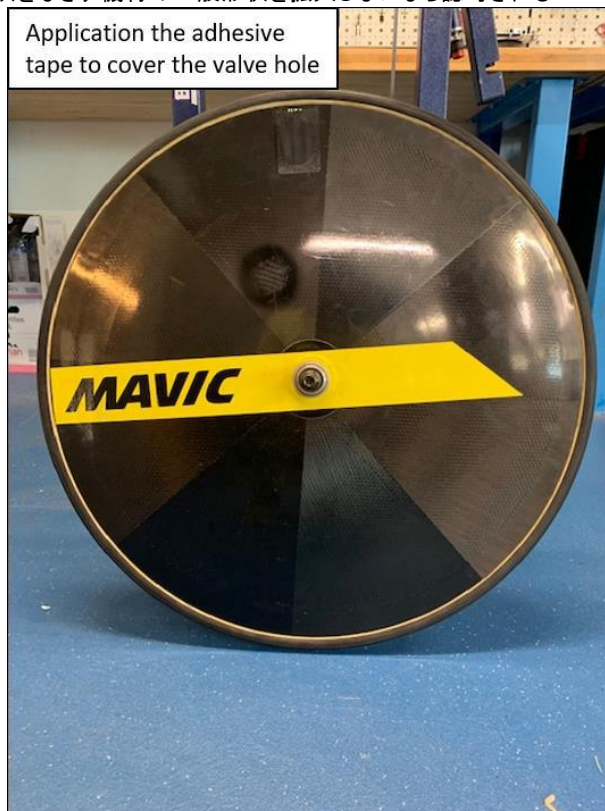
Figure 3 : The example of application the adhesive tape on the Time Trial disc wheel 図 3: タイムトライアル・ディスクホイールへの粘着テープ貼付の例
